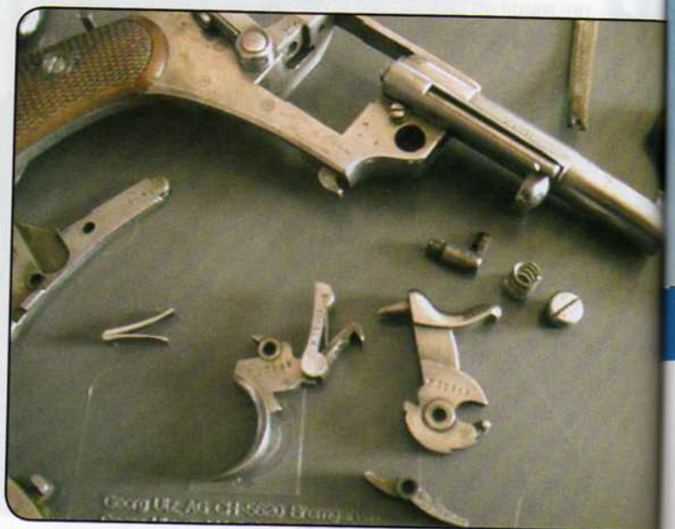
Démontage complet du mécanisme avec ordre de démontage. Vues de gauche et de droite.
