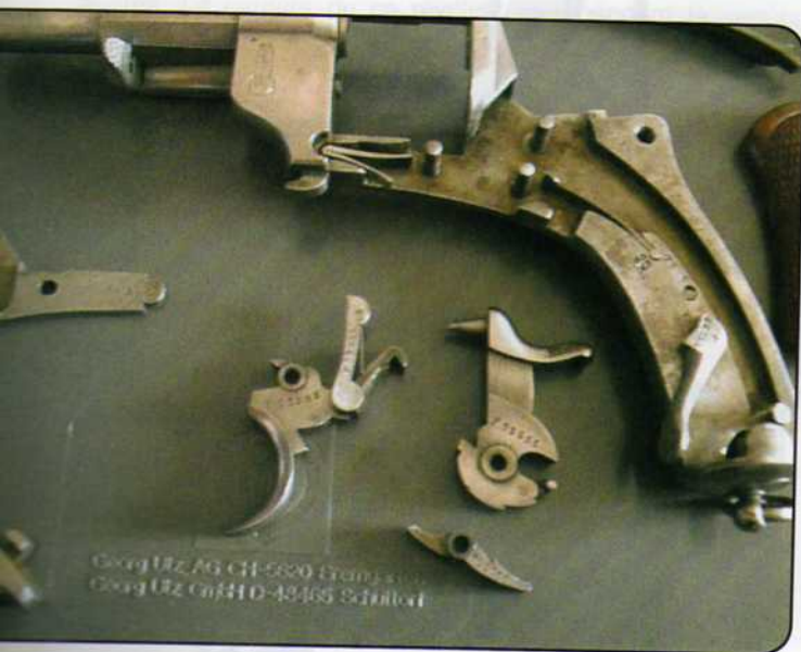
Démontage complet du mécanisme avec ordre de démontage. Vues de gauche et de droite.
