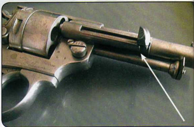
Démontage du barillet, déverrouillage de la came et extraction de l'axe.
