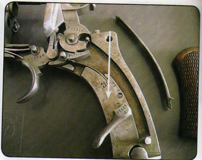
Démontage de la lame de ressort principal à l'aide de la pédale.
