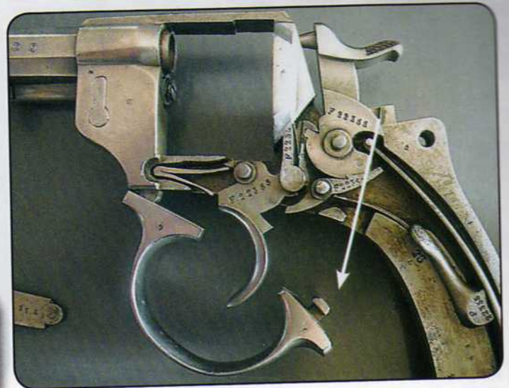
Plaque de carcasse démontée laissant le mécanisme visible. Démontage du pontet.
