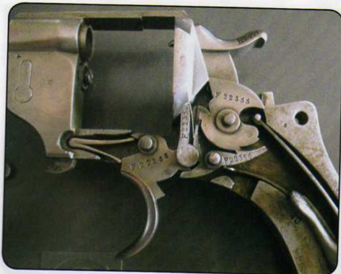
Démontage de la lame de ressort principal à l'aide de la pédale.
